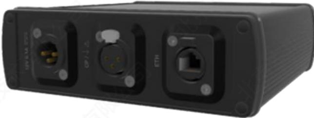
CCS Sniffer 工具可以帮助无缝观察电动汽车与充电桩之间的通信通道, 采集通信数据。
